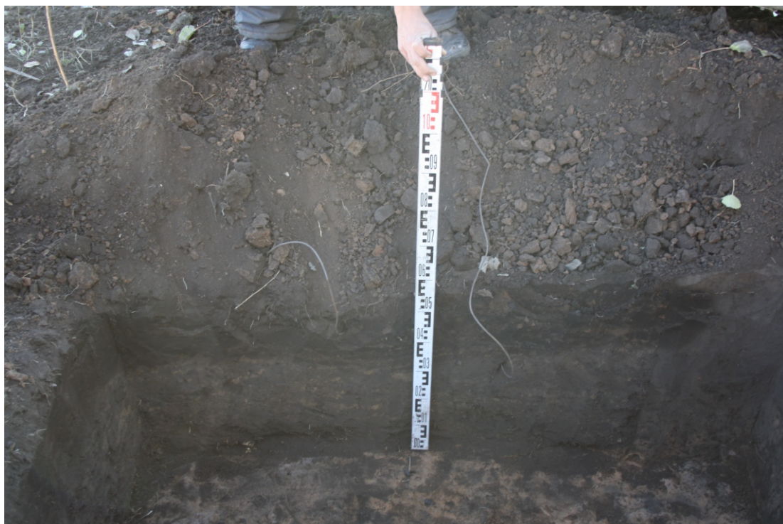
Рис.10. Объект «Замена технологических трубопроводов НПС «Бавлы» МН «Бавлы-Куйбышев». Бугурусланское РНУ. Реконструкция» на территории муниципального района Бавлинский Республики Татарстан. Профиль северной стенки шурфа 1.
